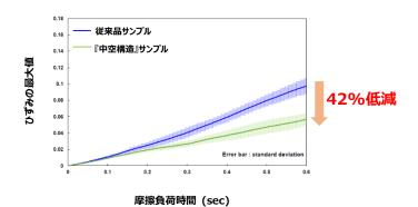
図 6.ひずみの最大値の経時変化<sup>※6</sup> 東北大調ベ(2021年6月) n=5
