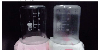
一般的な非通気性パッド 昼安心通気パッド (パッドの下にお湯を入れたピーカーを置き、 5分経過した時の様子) ※写真はふつうタイプ
